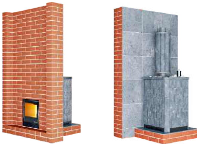
Рис. 5 Проход топочного канала
