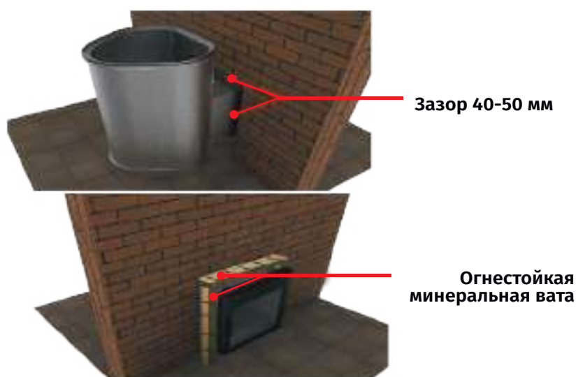
Рис.№ 5 Установка печи «Сквозь стену»
