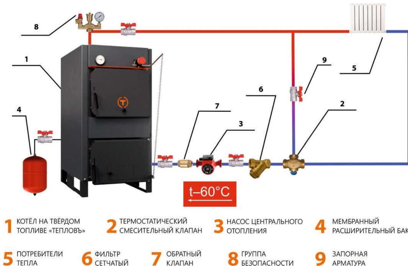
Рисунок 5. Типовая схема обвязки котла «ТЕПЛОВЪ» с 3-х ходовым клапаном
